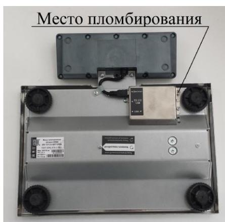
пломбировочная чашка устанавливается
