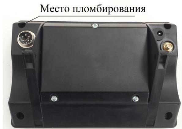
пломбировочная чашка устанавливается
